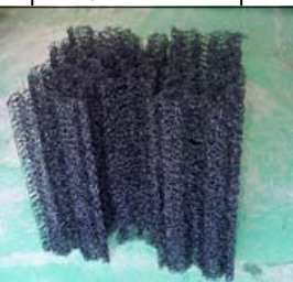
嫌気ろ床槽 第2室ろ材
