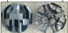
嫌気ろ床槽 第1、2室ろ材
