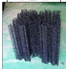
嫌気ろ床槽 第2室ろ材
