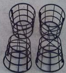
嫌気ろ床槽 第1室ろ材
