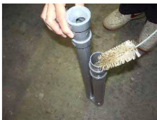
揚水管を洗浄
