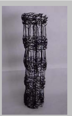
嫌気ろ床槽 第1室ろ材
