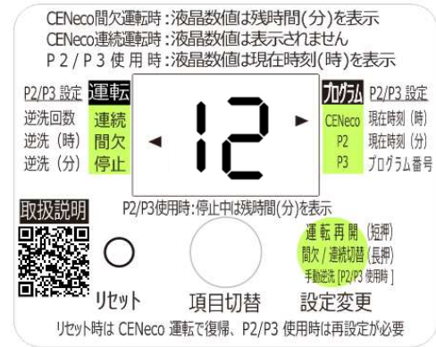
＜表示例：間欠運転モードでブロウが運転中の場合＞
