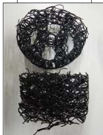
嫌気ろ床槽 第2室ろ材
