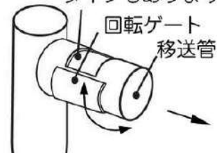
図 嫌気汚泥移送エアリフトポンプの確認
