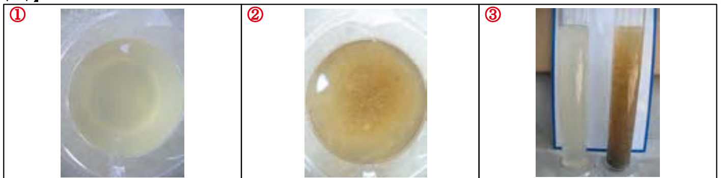
2次処理槽：逆洗前のばっ気液 (白濁し透視度13度)
