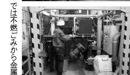
破碎選別ライン（上）では不燃ごみから金属 資源を回収する（下）
